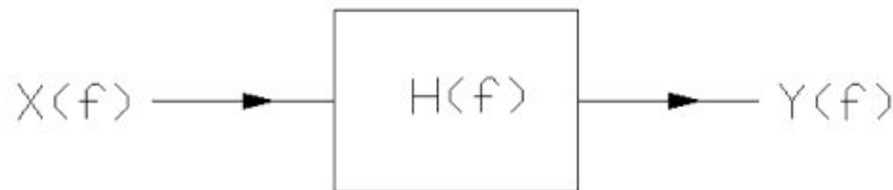
Figura 2. Modelo do sistema físico no domínio da frequência.
