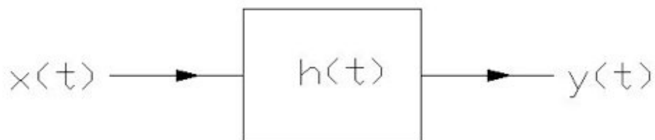
Figura 3. Modelo do sistema físico no domínio do tempo.
